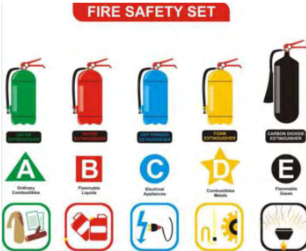
चित्र 4.2.4: आग बुझाने के विभिन्न वर्गों के लिए इस्तेमाल होने वाले अग्निशामक यंत्र
